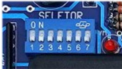
(conjunto de chaves de 1 a 7 na cor azul na placa de controle posicionada na parte superior no interior do atuador) servirá para reduzir o movimento máximo de deslocamento do cabo de engate como segue:
